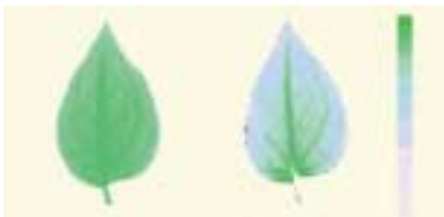
Lucent'ın Bell Laboratuvarlarında Nuss ve arkadaşlarının aldığı görüntü, sağdaki görüntüde yaprak bir kaç gün önce koparıldığı için su oranı düşük.
