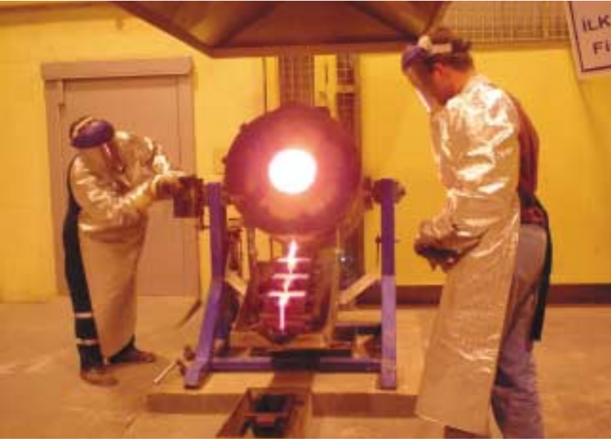
Karbon, çözeltilen sıyrıldıktan sonra, altın ve gümüş içeren çözelti, elektrolit hücrelerinden geçiriliyor. Elde edilen altın ve gümüş tanecikleri 1200°C'de eritilerek, son ürün olarak külçelere dökülüyor.
