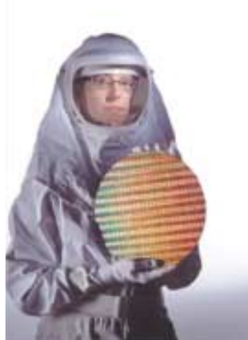
300 milimetre teknolojisi şu anda ulaşılan en ileri teknoloji. 30 cm çaplı yonga üzerine milyarlarca transistor yerleştirmek işten değil.
