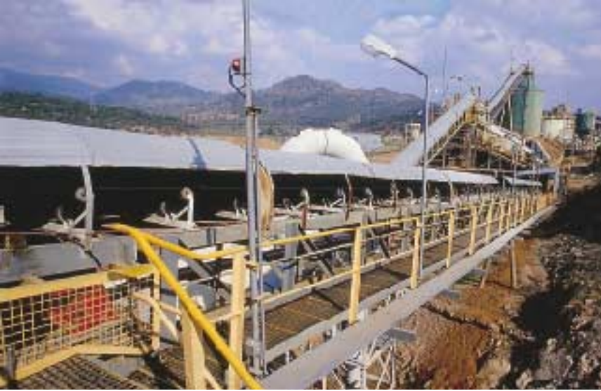
Yürüyen bantlarla kırıcıya gelen cevher, önce çeneli kırıcıdan geçiyor. Daha sonra titreşimli ekte istenilen tane boyutunu yakalayan parçacıklar, elekten geçerken, geçemeyenler yeniden kırıcıya gönderiliyor.
